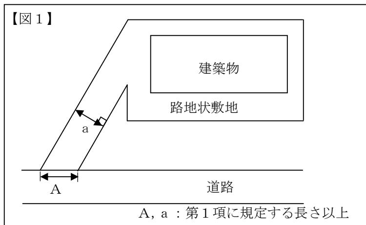
第2項は、大規模、中高層建築物が存する敷地の前面道路について規定したものであり、ここで規定する「幅員6メートル以上の道路」は、原則として路線（結節点間）の幅員が6メートル以上であることに留意されたい（図2、図3参照）。
